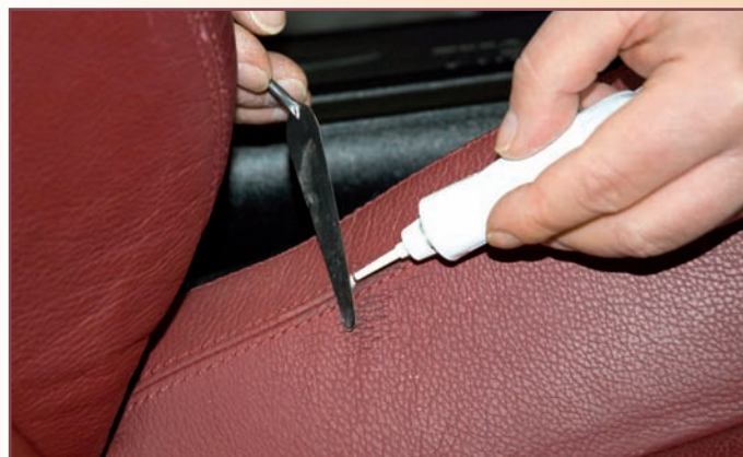
Schadhafte Stellen werden wieder aufgefüllt
