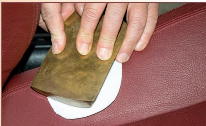
Der Strukturabdruck wird aufgepresst
